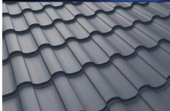
**Металлочерепица** – кровельный материал, представляющий собой листы, изготовленные из тонколистовой стали, алюминия или меди, покрытые полимерным защитным слоем, профилированные методом холодного давления. Листы металлочерепицы по внешнему виду напоминают кладку керамической черепицы.
