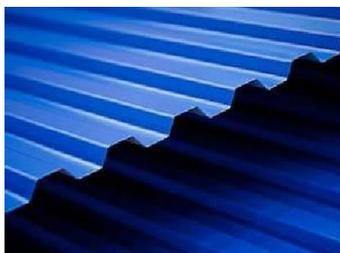
**Профнастил** производится из металлических оцинкованных листов путем специальной обработки – гофрирования либо профилирования. Для производства профнастила, как правило, применяется прочная оцинкованная сталь (оцинковка) толщиной от 0,4 до 0,7мм.
