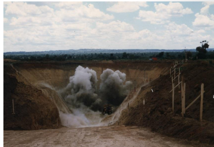
Пример риска: обрушение Годовое понижение горных работ 125 м Нормальное - 40-70 м в год
